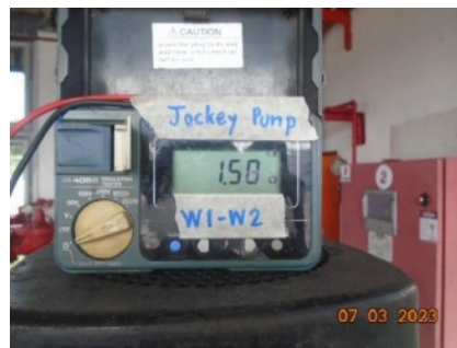
วัดค่าความต้านทานของแต่ละขดลวดของมอเตอร์
