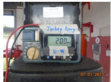
วัดค่าความเป็นฉนวนของขดลวดเทียบกับระหว่างขดลวด
